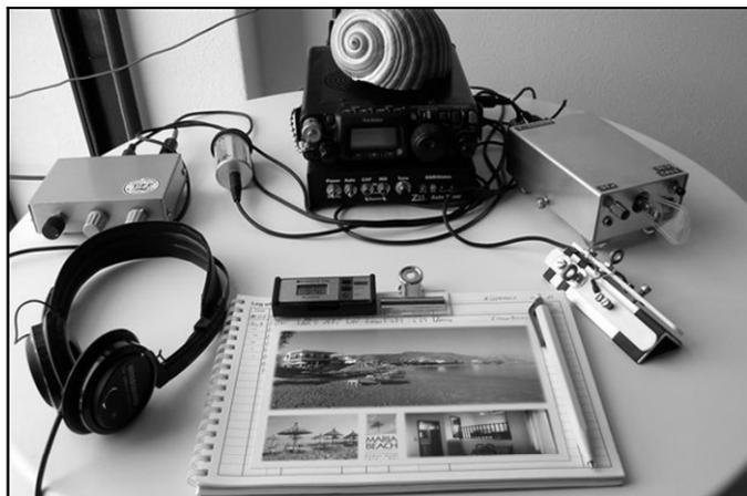
En SV9: FT-817, pwr 5Watts, petite alimentation à découpage, coupleur automatique "Z11", Ant: long fil de 13,5m avec un balun 1:9 et 13m de coax 50 Ohms .
